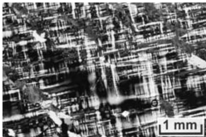
Fig. 4.- Micrografía obtenida por microscopía óptica con nícoles cruzados en la muestra Ac12, cuyos dominios de feldespatos sódico presentan aureolas de microclina con mesoestructura en "tablero de ajedrez" por alternancias claro oscuro que intersectan a 90°. La extensión limitada de las aureolas deja áreas en extinción de más baja triclinicidad.
